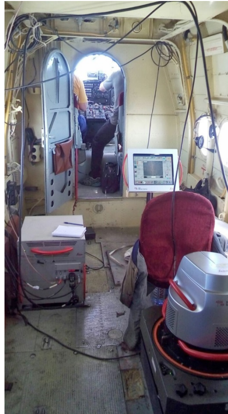
AG «Leica geosystems» өндірген ADS-40 әуе түсірімі кешені
